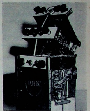
Bild 6. Die Baugruppen des DX-Funksprengergeräts; von oben nach unten: Endstufe, Vorstufe, Mischstufen, VFO, Quarzoszillator; ZF-Verstärker, Ringmodulator, Trägeroszillator, AM-Modulator; NF-Teil und Lautsprecher; Akkumulatoren
